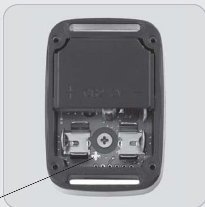
Označení polarity baterie
